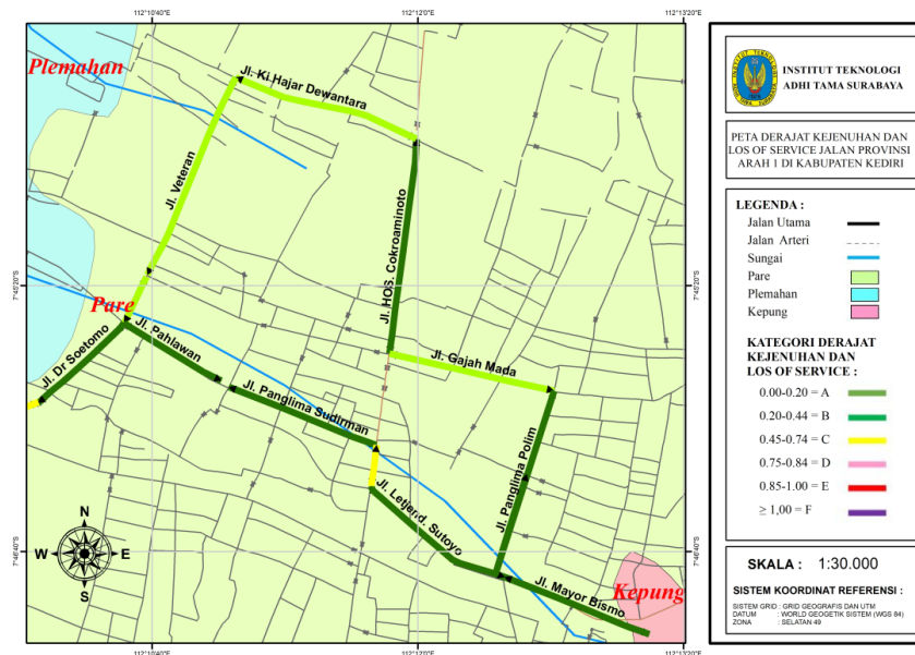
Gambar 9. Pemetaan derajat kejenuhan dan tingkat pelayanan jalan arah 1 pada Jalan Provinsi di Kabupaten Kediri
