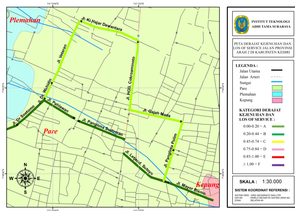
Gambar 11. Pemetaan derajat kejenuhan dan tingkat pelayanan jalan arah 2 pada Jalan Provinsi di Kabupaten Kediri.
