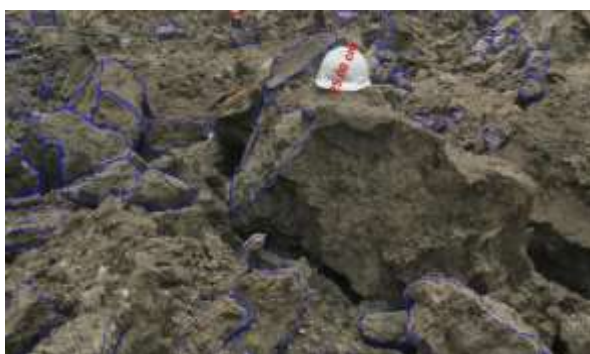
Gambar 2. Fragmentasi Aktual Tanggal 30 Oktober 2021 (Kiri), Kurva analisis fragmentasi tanggal 30 Oktober 2021 (Kanan)
