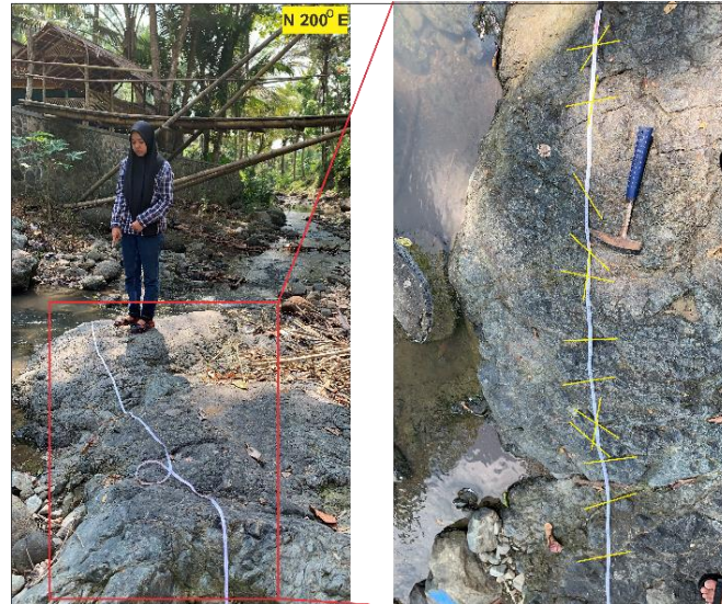
Gambar 6. Kenampakan Kekar pada Lava Andesit di LP 137
