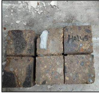
**Gambar 4:** Sampel batuan konglomerat setelah di preparasi, (a) Sampel ukuran butir kasar; (b) Sampel ukuran butir halus
