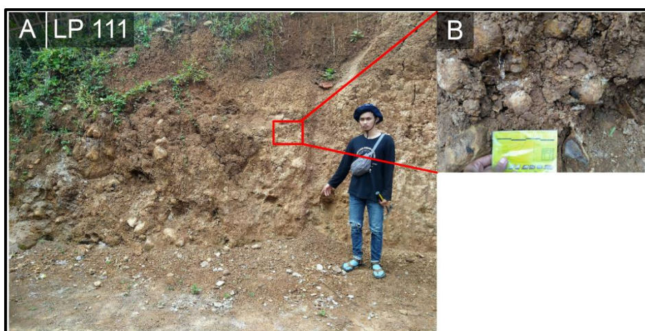
Gambar 13. Kenampakan singkapan satuan batupasir Jaten LP111 Daerah Pandean, Kecamatan Dongko, Kabupaten Trenggalek. (A) Foto singkapan konglomerat Jaten dengan azimuth N 346° E. (B) Foto litologi konglomerat pada singkapan LP 111
