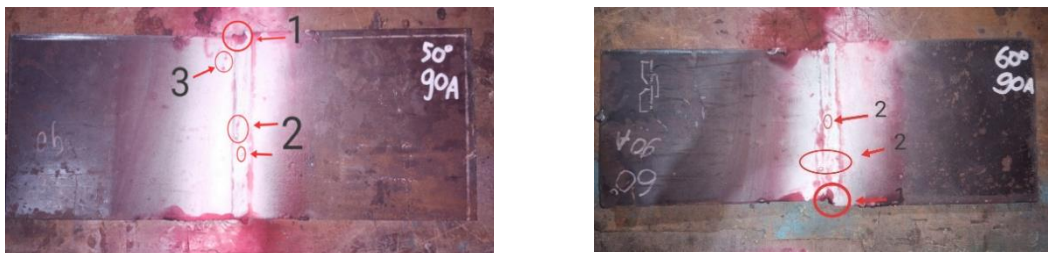
Gambar 5 Hasil uji penetrant test pada 90 ampere dengan sudut 50° dan 60° (Sumber: Dokumen pribadi)
