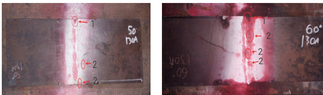
Gambar 7 Hasil uji penetrant test pada 130 ampere dengan sudut 50^\circ dan 60^\circ (Sumber: Dokumen Pribadi)
