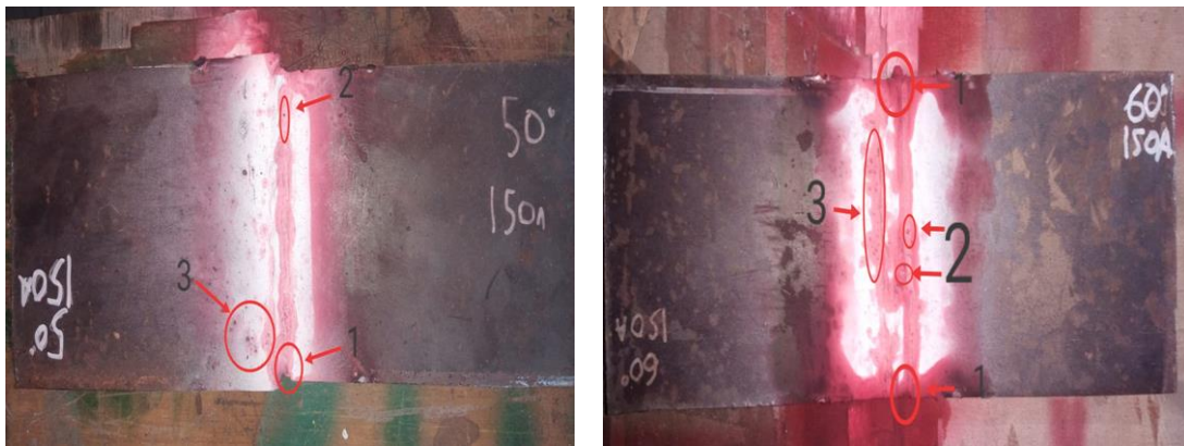
Gambar 8 Hasil uji penetrant test pada 150 ampere dengan sudut 50^\circ dan 60^\circ (Sumber: Dokumen Sendiri)
