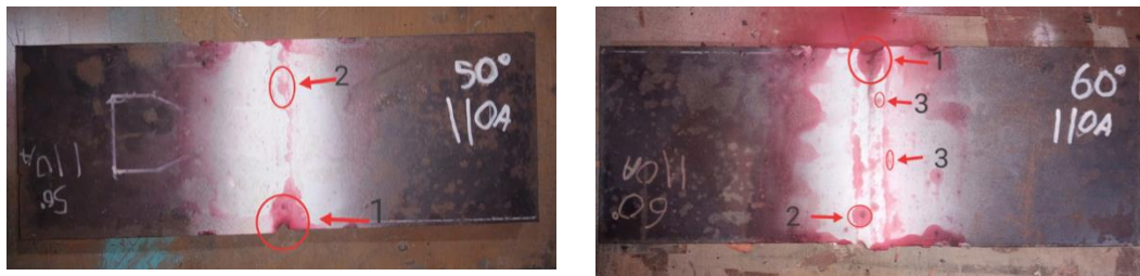
Gambar 6 Hasil uji penetrant test pada 110 ampere dengan sudut 50^\circ dan 60^\circ (Sumber: Dokumen pribadi)
