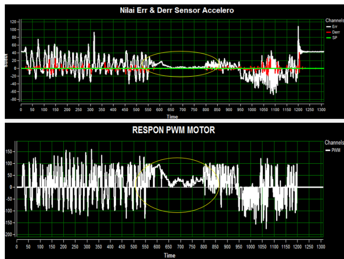
Gambar 9. (a) Hasil Pembacaan Sensor Accelerometer saat Scooter dikendarai dan (b) Nilai PWM yang dihasilkan oleh FLC
