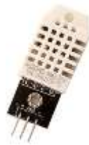
Gambar 3. Sensor Suhu dan Kelembaban (DHT22).
