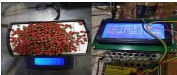
Gambar 8. Hasil Timbangan Digital Dan Timbangan Load Cell
