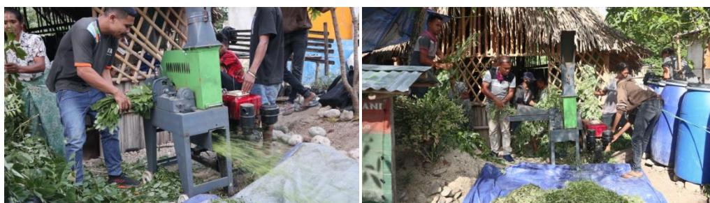
Gambar 1. Pencacahan Hijauan menggunakan mesin cacah
