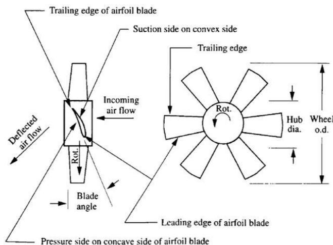
**Figure 1** Axial fan dimension parameter [3]
