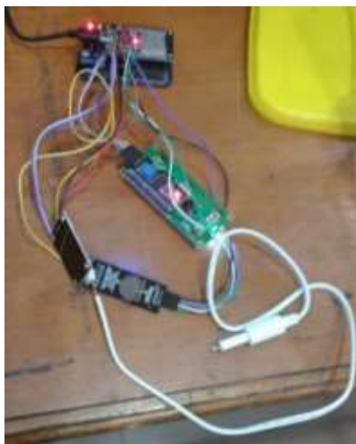
Gambar 6 : Prototipe Pendeteksi Cerdas Tingkat Salinitas Gracilaria sp
