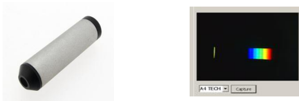
Gambar 5. Monokromator dan spektrum yang dilihat dengan kamera
