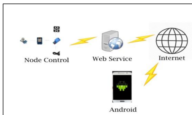
Gambar 1. Arsitektur Jaringan Pengontrolan Sistem
