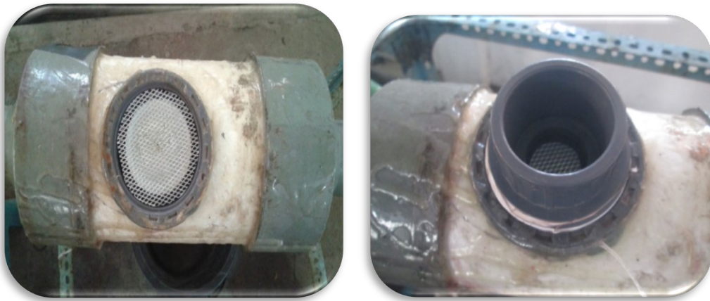
Gambar 1. Peletakan membran pada reaktor cross flow
