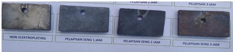
**Gambar 6.** Material Katoda yang dilapisi Anoda Seng
