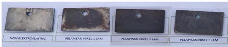
**Gambar 7.** Material Katoda yang dilapisi Anoda Nikel
