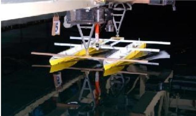
**Gambar 3.** Pengujian Hambatan Model Lambung katamaran
