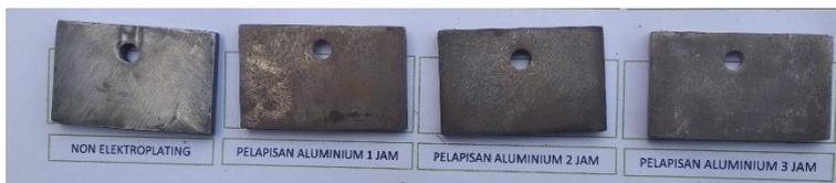
**Gambar 5.** Material Katoda yang Dilapisi Anoda Aluminium
