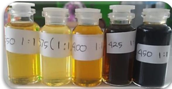
Gambar 7. Biofuel dari RBD Stearin solid dengan perengkahan katalitik pada berbagai temperatur (a)-(e) berturut-turut pada temperatur 350,375,400,425 dan 450 °C menggunakan katalis Zn-HZSM-5/ $\gamma$  alumina (1:1) [28].
