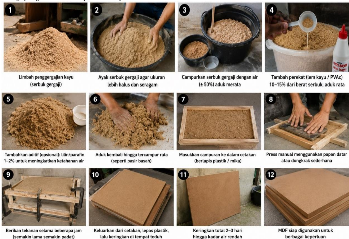
Gambar 4. Ilustrasi proses pembuatan MDF ( medium density fiberboard ).
