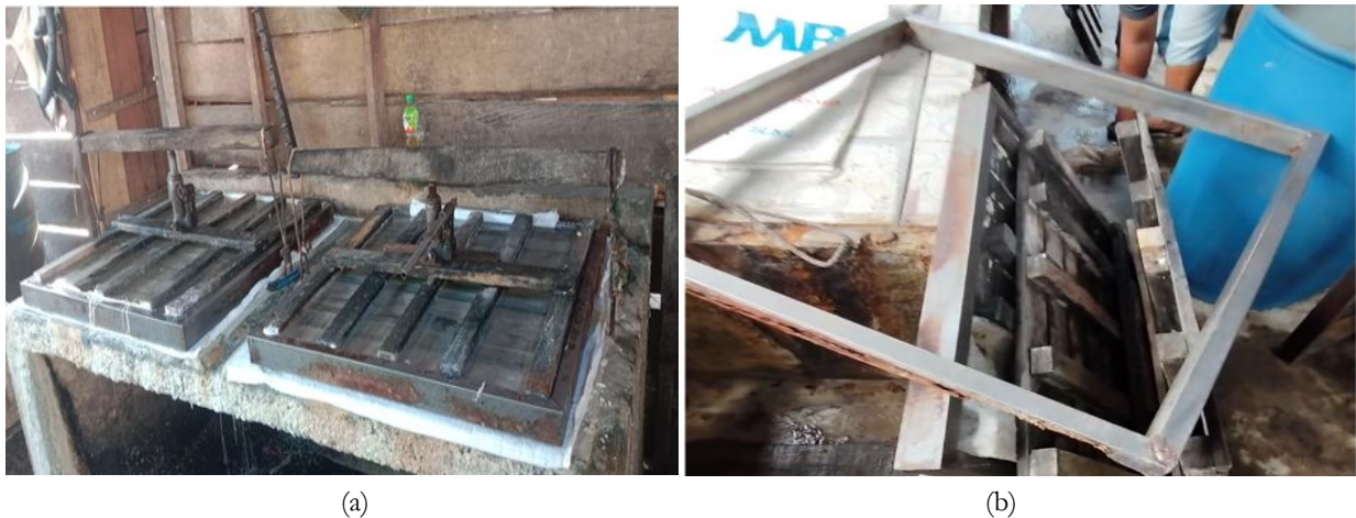
Gambar 1. Kondisi alat pencetak tahu mitra sebelum kegiatan PKM: (a) alat cetak yang telah berkarat dan permukaannya rusak; (b) rangka alat lama yang mengalami korosi dan kerusakan struktur logam.
