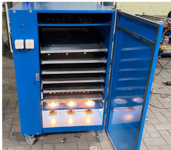
Gambar 3. Realisasi Alat Inkubator Fermentasi Tempe
