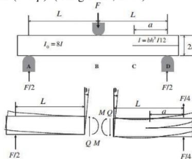
Gambar 9. Spesimen ENF dan sketsa analisis mekanika
