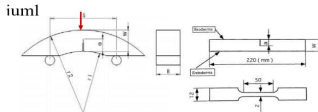
Gambar 7. (a) Gaya lengkung bambu ; (b) Retakan pada bambu
