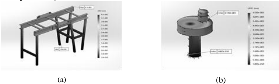
Gambar 4. a) Displacement Untuk Rangka, b) Displacement Untuk Part Sistem Penggerak
