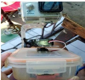
Gambar 7. Mekanik penggerak *Action* kamera
