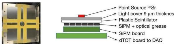
Gambar 4. Percobaan setup dengan sumber tipe titik <sup>90</sup>Sr dengan penutup aluminium. Di sebelah kiri adalah foto percobaan dan di sebelah kanan adalah tata letak strukturnya.
