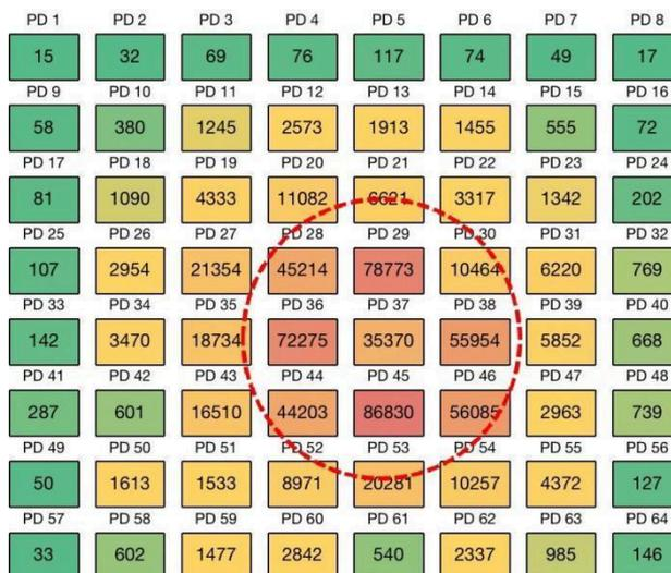
Gambar 6. Peta warna didasarkan pada jumlah hitungan di setiap saluran untuk percobaan <sup>90</sup>Sr.
