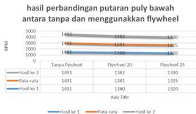
Gambar 4 Hasil Perbandingan Putaran Pulley Bawah Antara Tanpa Dan Menggunakan Flywheel.
