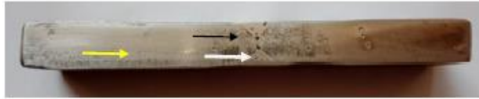
Gambar 7 Titik indentasi pada posisi pengelasan 3G dengan tipe elektroda E308 dan diameter 2,6mm
