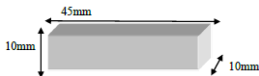
Gambar 1. Dimensi Spesimen yang akan di Las
