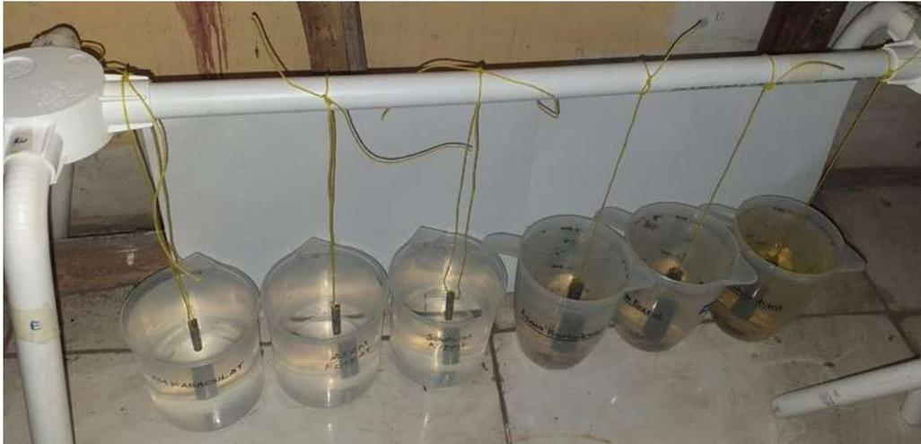
Gambar 1. Baja bertulang diatur dalam posisi menggantung saat dimasukkan ke media korosif HCl
