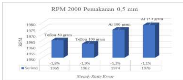
Gambar 12 Grafik Hubungan Antara Rpm 2000, Pemakanan 0,5 mm dan Steady State Error
