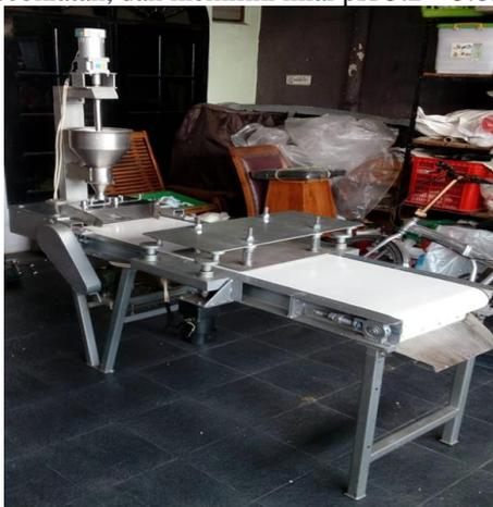
Gambar 1. Alat pembulatan adonan dengan system putaran eksentrik
