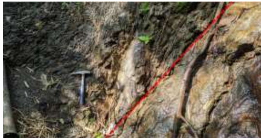
Gambar 10: Salah satu singkapan batuan yang menunjukkan kontak antarsatuan batulempung dan andesit yang dibatasi oleh bidang, diinterpretasikan sebagai sesar naik (garis putus-putus berwarna merah dengan orientasi N65^{\circ}E/47^{\circ} ). Batulempung di sebelah kiri garis, andesit di sebelah kanan garis merah.
