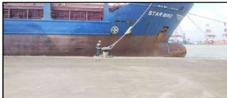
Gambar 1. Proses pemasangan tali tambat pada kapal yang akan berlabuh oleh petugas pelabuhan.
