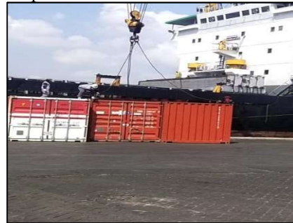
Gambar 5. Pekerja sedang memasang atau melepas hook kontainer.
