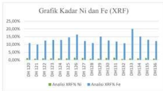
Gambar 3. Grafik kadar Ni dan Fe (XRF) untuk mengetahui kadar ni dan fe tertinggi
