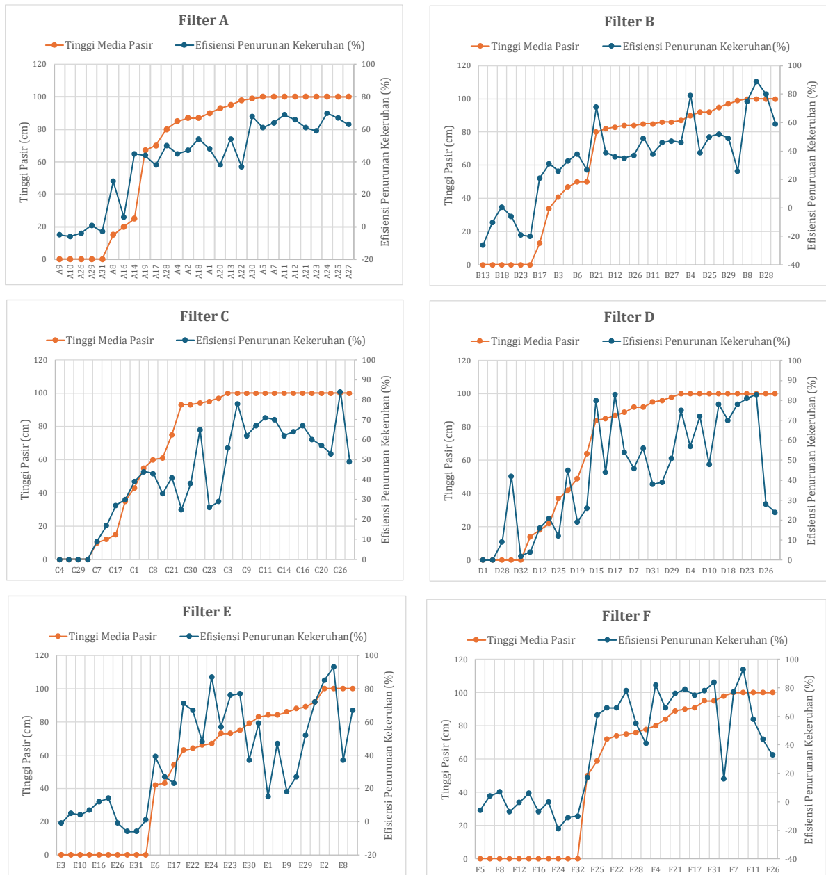
Gambar 5. Hubungan antara ketebalan media pasir silika pada setiap petak saringan pasir cepat dengan efisiensi penurunan kekeruhan
